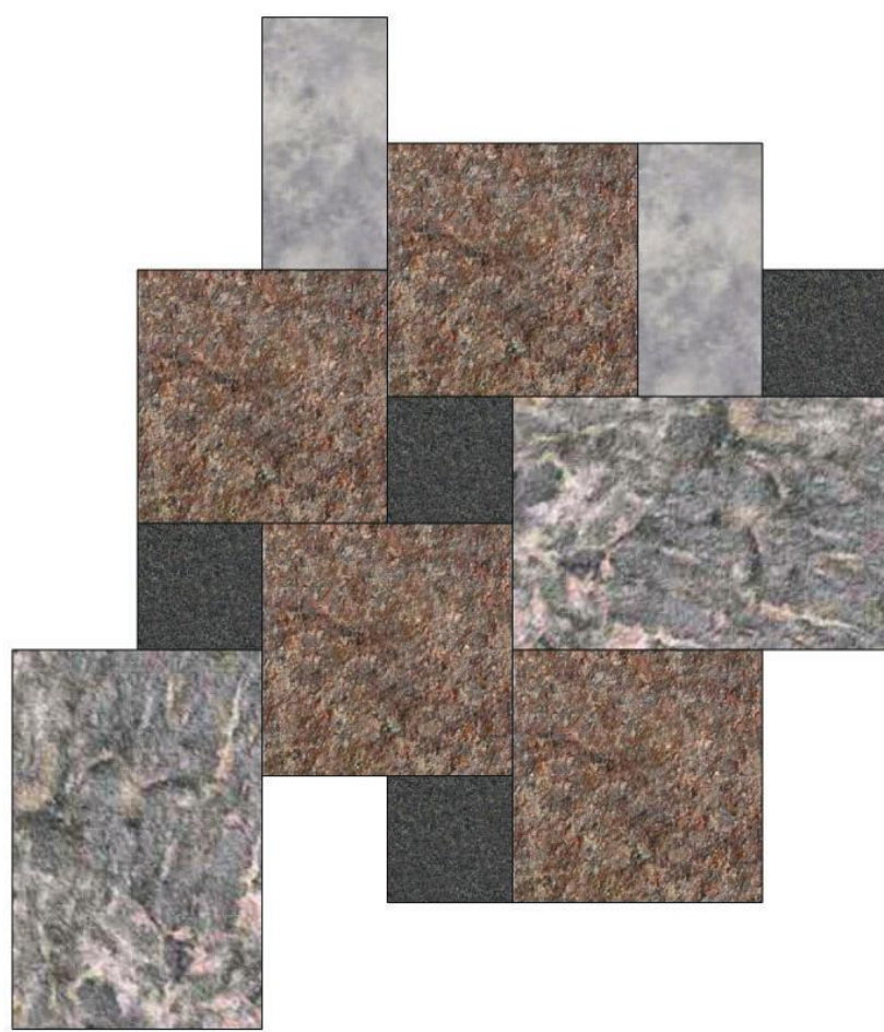
Detalj 2b: Beleggingsmønster. Det er brukt fire ulike dimensjoner av heller som legges i et rubbelmønster.
