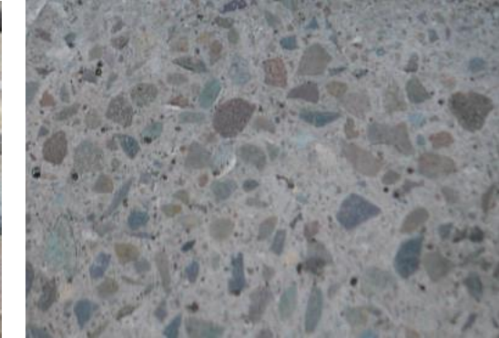
Betong med tilslag av gjenbrukt tegl
